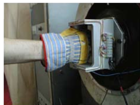
Bild: Utrustning för test av vibrationsdämpande handskar enligt standard EN ISO 10819.
