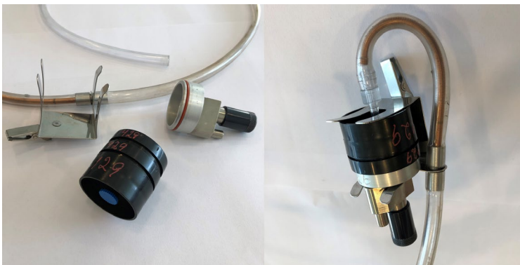
Bild 1. Bild på de olika delarna; föravskiljare (cyklon), filterkassett och provtagningshållare, var för sig samt en monterad provtagare.
