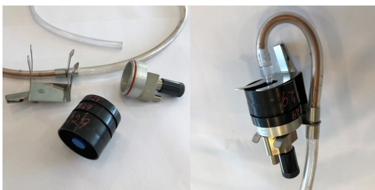
Bild 1. Bild på de olika delarna; föravskiljare (cyklon), filterkassett och provtagningshållare, var för sig samt en monterad provtagare.
