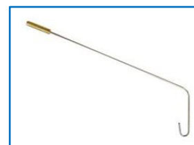
Fig 11. Mätkrok för mätning av statiskt tryck i frånluftsentil
