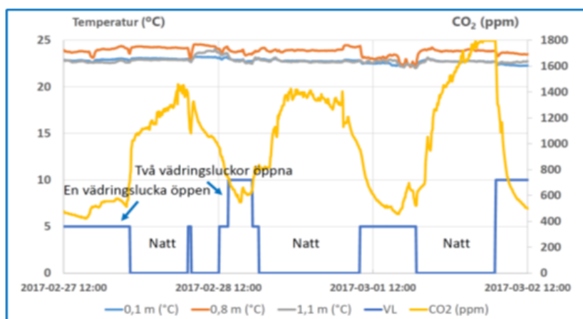
Figur 15. Exempel på loggning av temperatur och koldioxidhalt i sovrum. Effekten av stängda vädringsluckor syns tydligt
